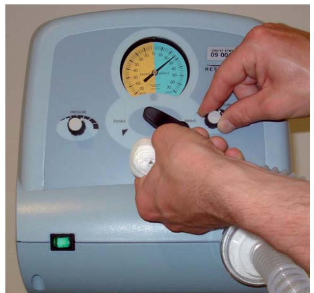
Figure 7. Régler ensuite le niveau de pression inspiratoire en tournant la mollette centrale vers « Inhale ». Adapter le niveau de pression avec le bouton de limite de pression inspiratoire.
