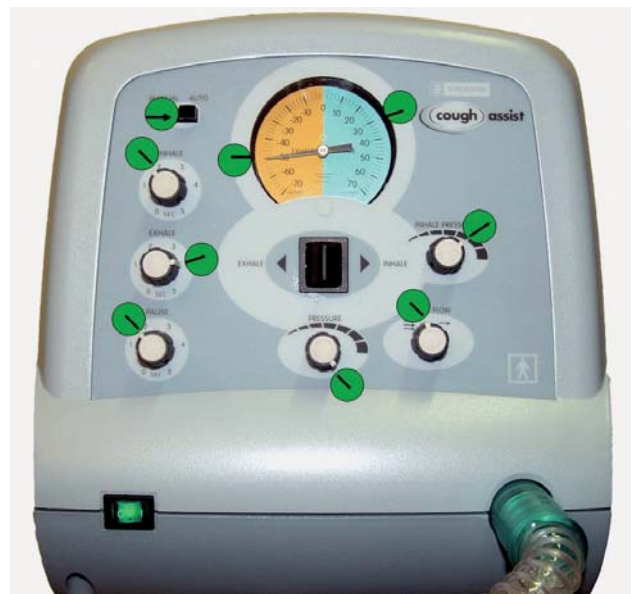
Figure 10. Pour une utilisation à domicile, nous indiquons les réglages avec des repères collés sur l'appareil.
